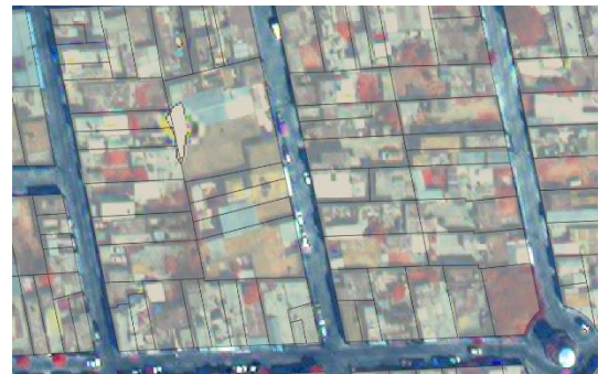
B) Imagen georreferenciada con transformación Helmert
