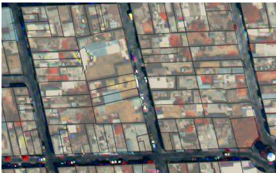
C) Imagen georreferenciada con transformación lineal
