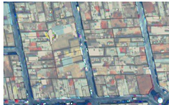
B) Imagen georreferenciada con transformación Helmert
