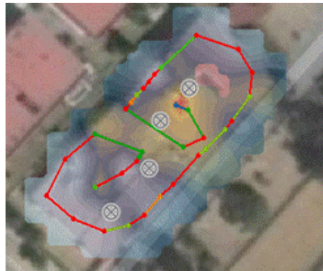
Figura 41. Cobertura real de la red inalámbrica en la Biblioteca de área académica "El Cerrillo"
