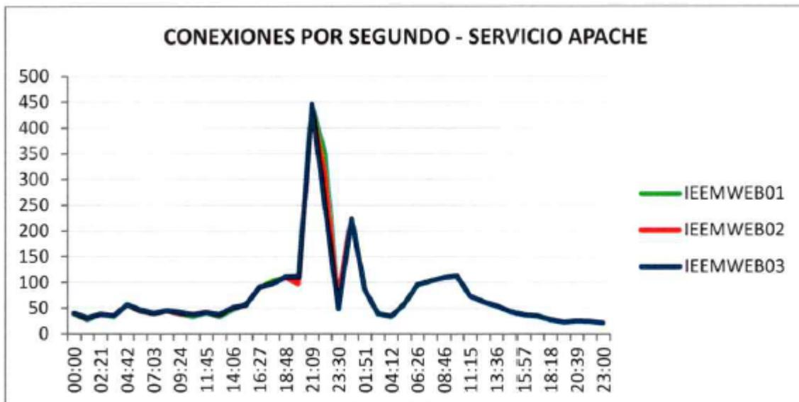
Figura 26. Conexiones por segundo al servicio apache en los tres servidores web por ISP 2
