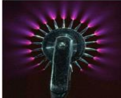
Figura 6 Descarga corona en rueda de Wartenberg.
