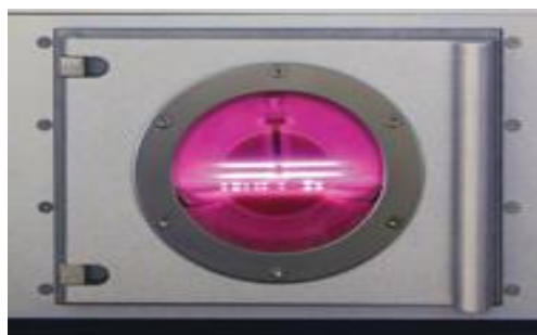
Figura 5 Plasma generado en cámara de vacío.
