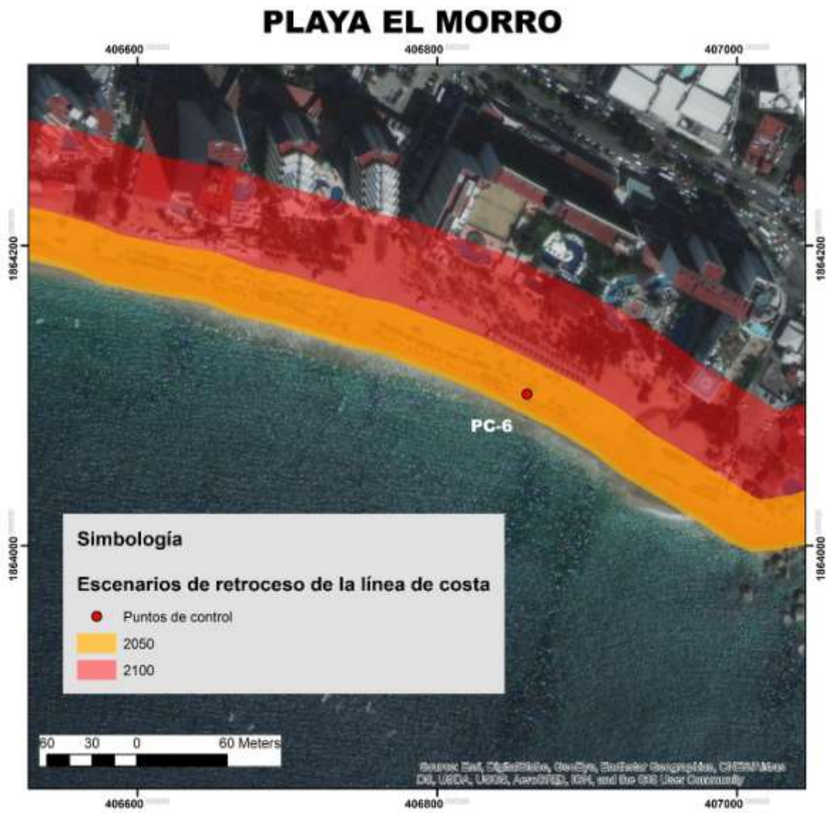
Figura 4.25. Escenarios de retroceso de la línea de costa para la playa El morro.
