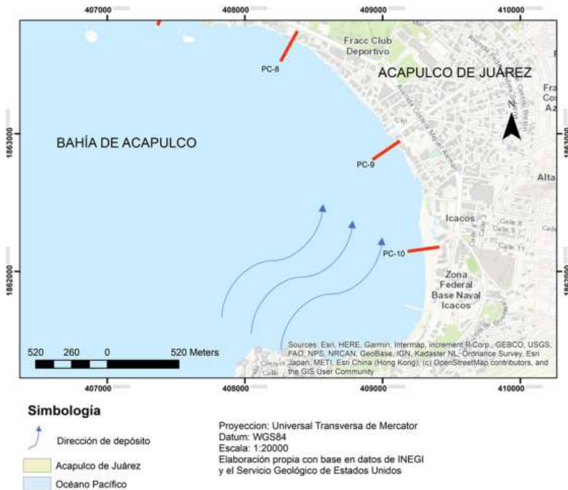
Figura 4.22. Dirección de depósito y puntos de mayor erosión.
