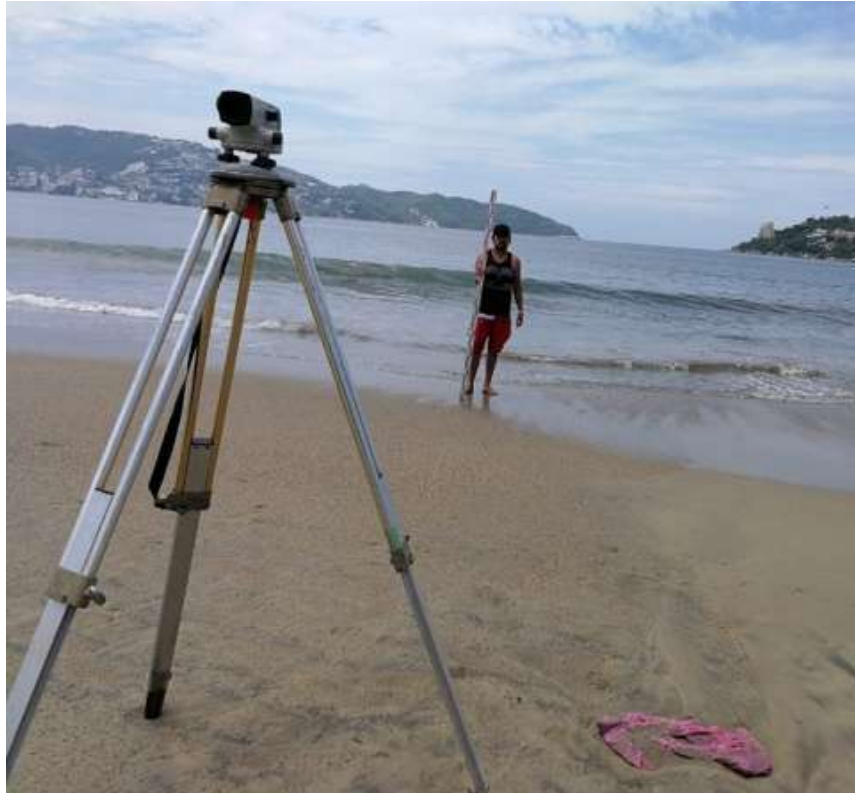
Figura 3.8. Levantamiento de perfiles de playa en la bahía de Acapulco.
