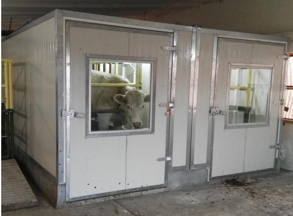
Figura 8. Cámaras de respiración de circuito abierto con bovino Charoláis en su interior.
