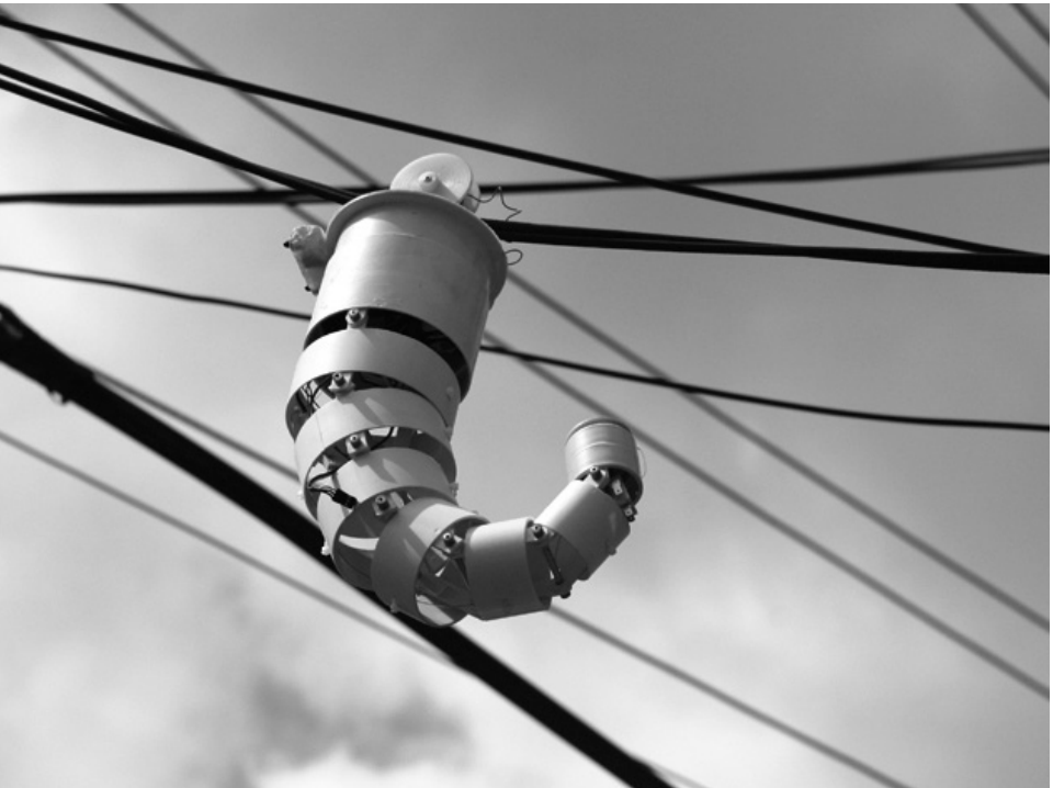
clgd Del proyecto Parásitos urbanos / Motores, pedazos de tubo de PVC, aluminio micro controladores, sensores / 2007.
