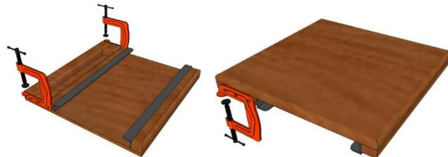
Se cortan dos piezas de neopreno o caucho y se colocan en los elementos de presión de cada prensa a fin de no lastimar los muebles.
