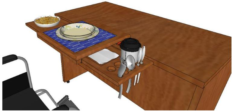
Base invertida con dos extensiones lisas para apoyo de objetos (disminuye la altura final)
