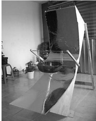
C. Incorporación de reflectores con perfil parabólico a cada lado del concentrador multicompuesto.
