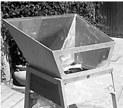
K. Mejoramiento del elemento estructural y de manejo del modelo, incorporación de pintura a la cocina.
