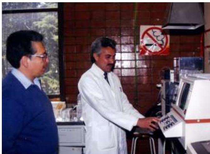
Foto No. 14. Quím. Miguel Ángel Molina Ángeles con el equipo químico analítico del laboratorio de aguas, *Espectrofotómetro de Absorción Atómica*, marca Varian, modelo StrAA-10 plus, recibido en el año 1993.
