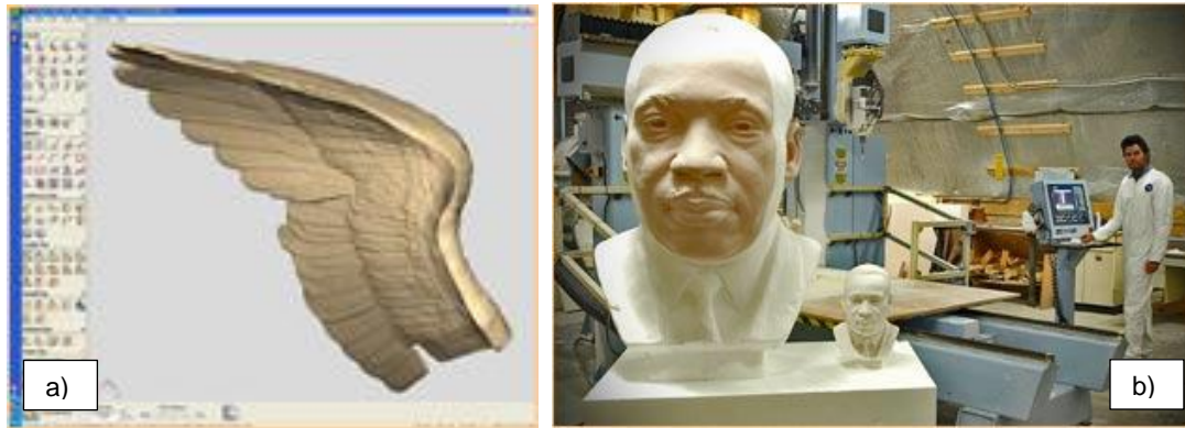
Figura 2.50. El taller de producción LaranBronze Inc., a) Ala restaura colocada en espejo, b) Foto de escaneado 3D y ampliación (Fuente: http://laranbronze.com/3d-scanning-and-enlarging/ , consultado el día 22 de noviembre de 2013).
