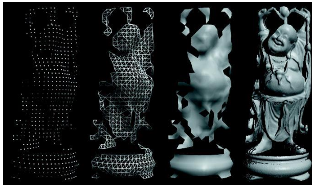
Figura 2.21. Imagen del rango de al variar la superficie. a) Imagen Rango (submuestreada). b) Después de crear triángulos. c) la prestación de sombra. d) superficie del campo de alta resolución. (Fuente: http://www.siggraph.org/publications/newsletter/v33n4/ , consultado el 15 de marzo de 2015).
