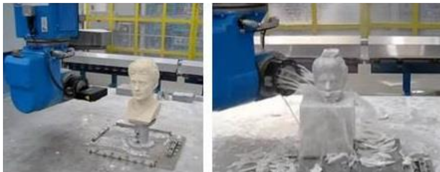
Figura 2.51. Escaneo 3D y el corte en una máquina CNC de 5 ejes, imágenes obtenidas de video Youtube (Fuente: http://www.youtube.com/watch?v=1p-nTYKPo_I , consultado el 29 de marzo de 2014).
