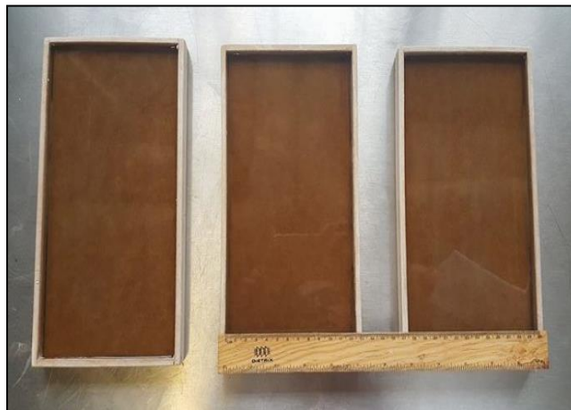
Ilustración 15 Paletas de resina 10 x 5 pulgadas.
