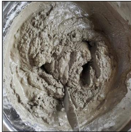
Ilustración 32 Dispersión de nanosílice en mortero.
