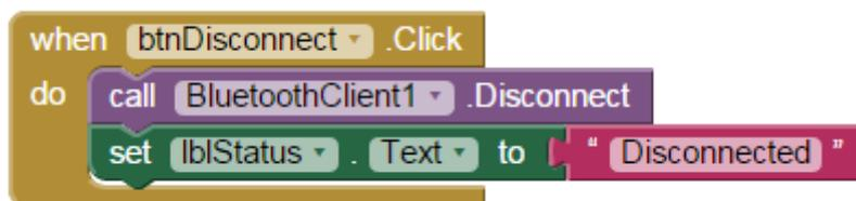
Figura 34. Componentes para conectar o desconectar Bluetooth
