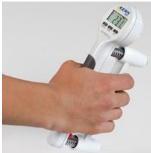
Figura 1.2: Transductor de Fuerza para mano.
